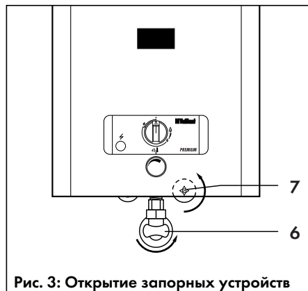
Рис. 3: Открытие запорных устройств
