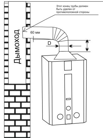
6.3.3. Соединение аппарата с дымоотводящей трубой должно быть герметичным.
