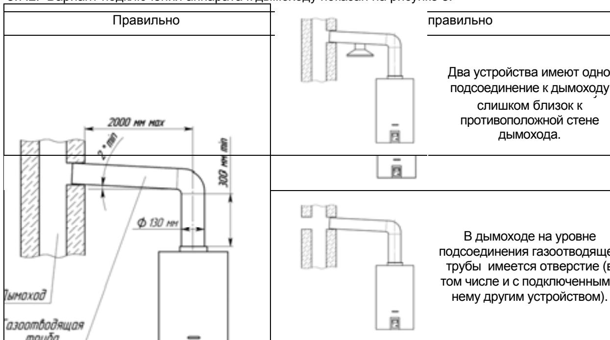
Рисунок 8. Подключение аппарата к дымоходу.
