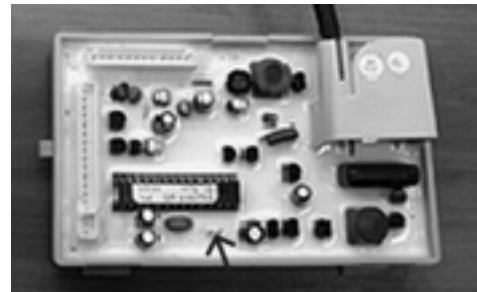
**Рисунок 9. Место установки перемычки в регуляторе розжига**
