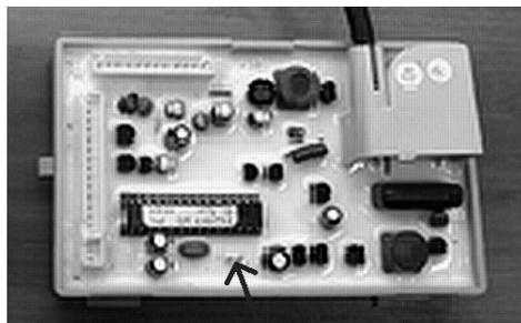
**Рис.11 – Место установки джампера в контроллер.**
