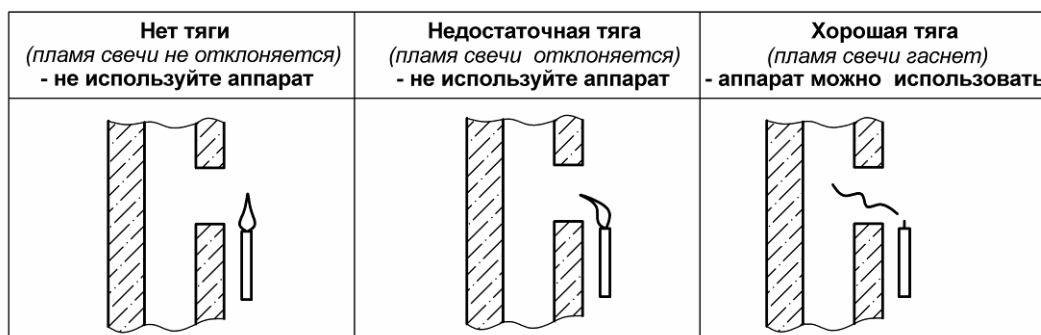
Рисунок 3. Простейший способ проверки тяги в дымоходе
