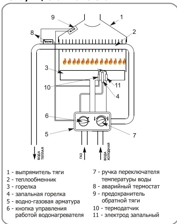
Основной функциональной частью водонагревателя является узел, состоящий из совмещенной компактной универсальной водно-газовой арматуры, газовых основной и запальной горелок. Над основной горелкой расположен теплообменник, обеспечивающий передачу тепла от продуктов сгорания в протекающую воду.
