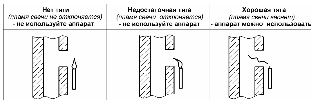
Рисунок 4. Способ проверки тяги в дымоходе
