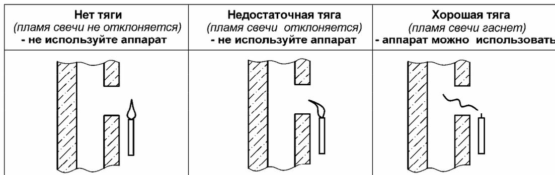
Рисунок 4. Способ проверки тяги в дымоходе
