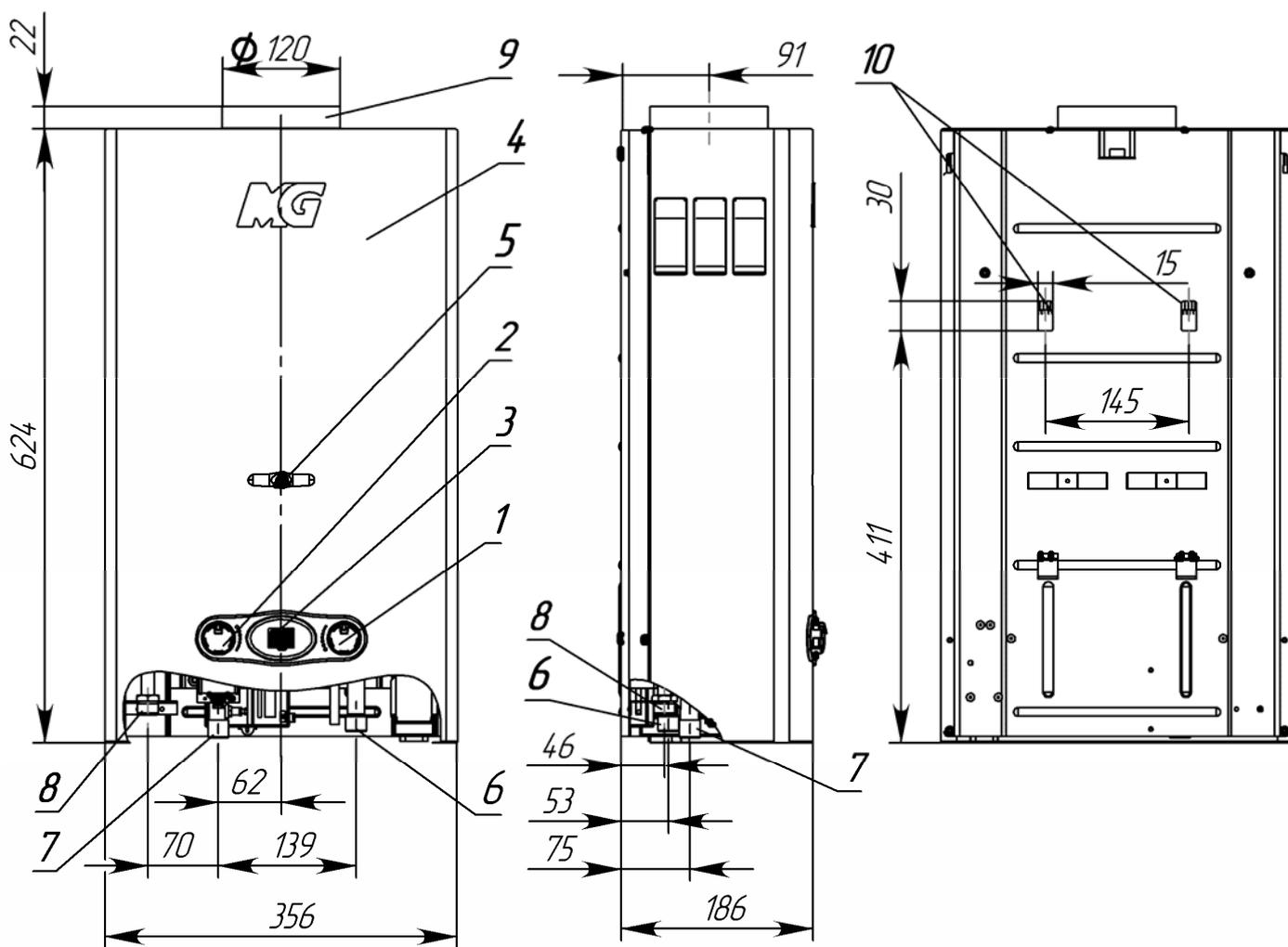
1 – ручка регулировки расхода воды; 2 – ручка регулировки расхода газа; 3 – дисплей температуры воды; 4 – облицовка; 5 – окно смотровое; 6 – штуцер подвода холодной воды, резьба G 1/2; 7 – штуцер подвода газа, резьба G 1/2; 8 – штуцер отвода горячей воды, резьба G 1/2; 9 – патрубок газоотводящего устройства; 10 – монтажные отверстия.
