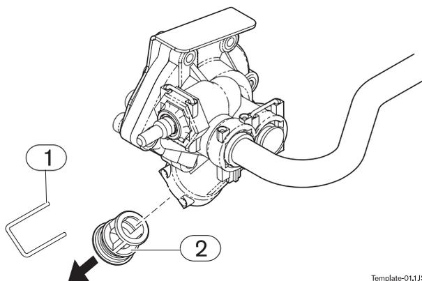
Рис 15 Опорожнение прибора
